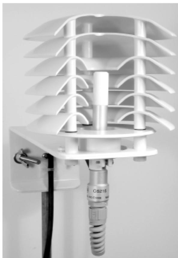
Un capteur CS215 monté à l'intérieur d'un abri de type 41303-5 (version spécialement coupé pour la photo).
